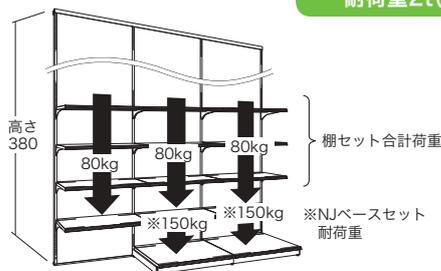
**注意** 天地固定柱は天井・床の下の材の材質・厚さ・固定方法等により強度が異なりますのでご注意ください。
